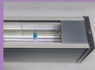
Exemple : une tache d'encre sur une fenêtre en quartz réduit la dose d'UV de 48 % sous la zone contaminée - cela ne peut pas être détecté par les capteurs statiques en ligne.
