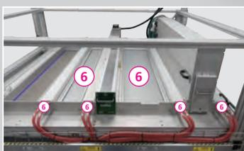
Vue aérienne - Chambre inerte avec injecteurs d'azote réglables
