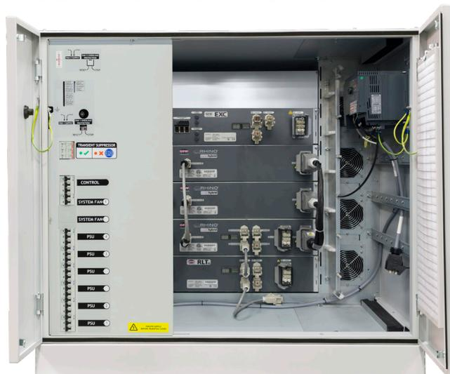
Les blocs d'alimentation (PSU) RHINO/RLT fournissent le type de courant correct pour les têtes de lampe à prégélification et à durcissement final au mercure ou à DEL. Le transformateur ExciRay se trouve dans la même armoire RHINO et l'ensemble du système est contrôlé à partir d'un seul écran tactile, offrant une solution clé en main facile à utiliser.
